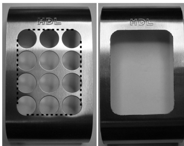
FIGURA 12 - Modificação na mecânica do Módulo de Acesso com Teclado da HDL.
